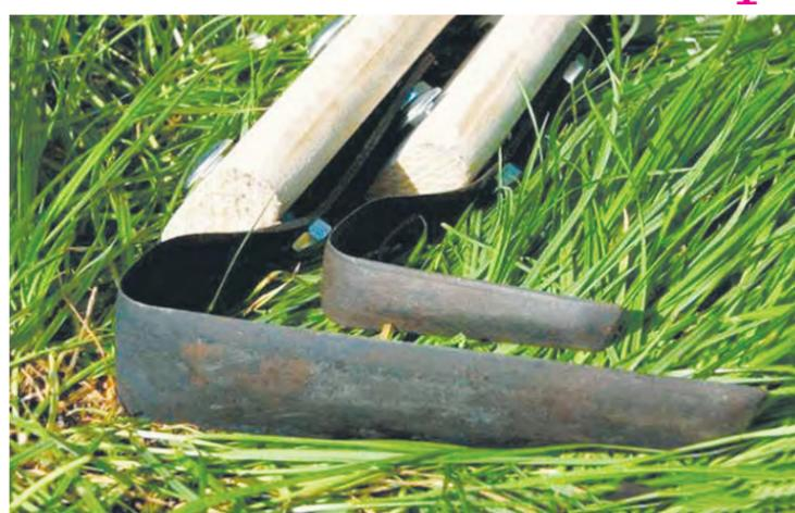
инструмент, который позволил выполнять работу в огороде быстро, не прикладывая чрезмерных усилий. Основное предназначение инструмента - делать плоский рез почвы, заглубляя режущую часть на 2-5 см в землю, срезая либо выдергивая все попадающиеся сорняки. С его помощью земля рыхлится без переворачивания пласта, верхняя часть сорняков
